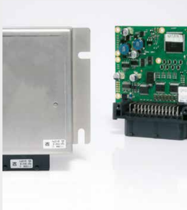
Bild links: Einbau eines MRS Steuergerätes M2600 in eine prototypische E-Fahrzeugplattform Bild rechts: Programmierbares Steuergerät M2600 ECO CAN
