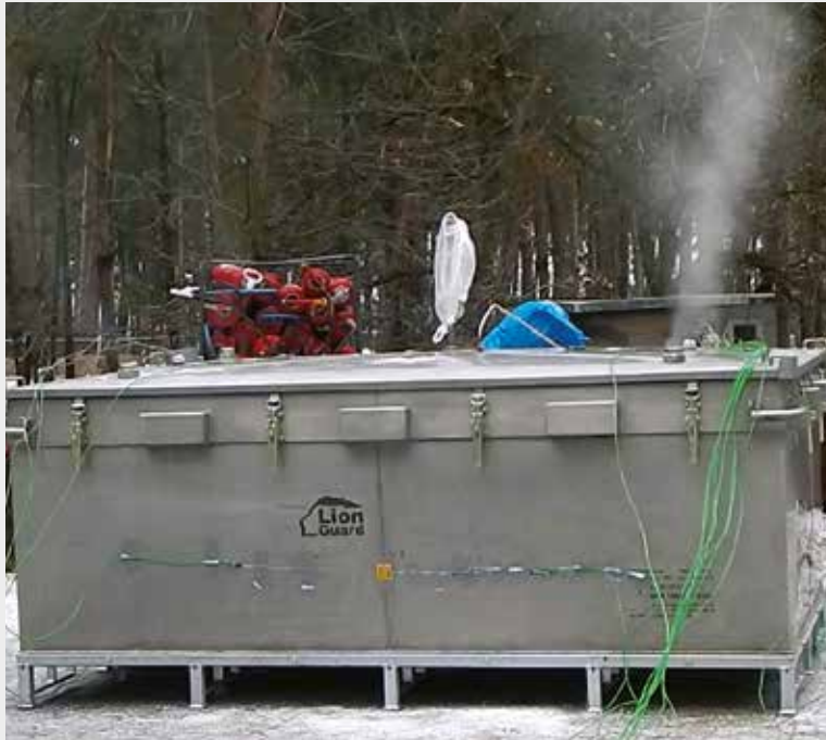
Bild links: Reaktionsgasfreisetzung aus Gefahrgutbehältern bei Batterie-Tests
