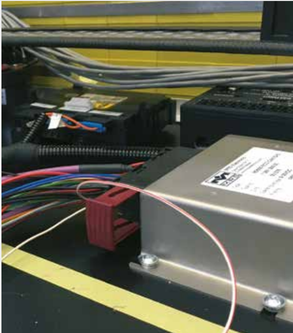
Bild links: Einbau eines MRS Steuergerätes M2600 in eine prototypische E-Fahrzeugplattform Bild rechts: Programmierbares Steuergerät M2600 ECO CAN
