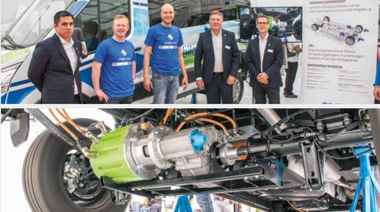
Bild oben: Entwicklerteam der Otto-von-Guericke-Universität Magdeburg und Ambulanz Mobile GmbH & Co. KG, RETTmobil 2018: Erster Hybrid-KTW wird vorgestellt / Bild unten: E-Drive-Modul der Universität Magdeburg für Krankentransportwagen
